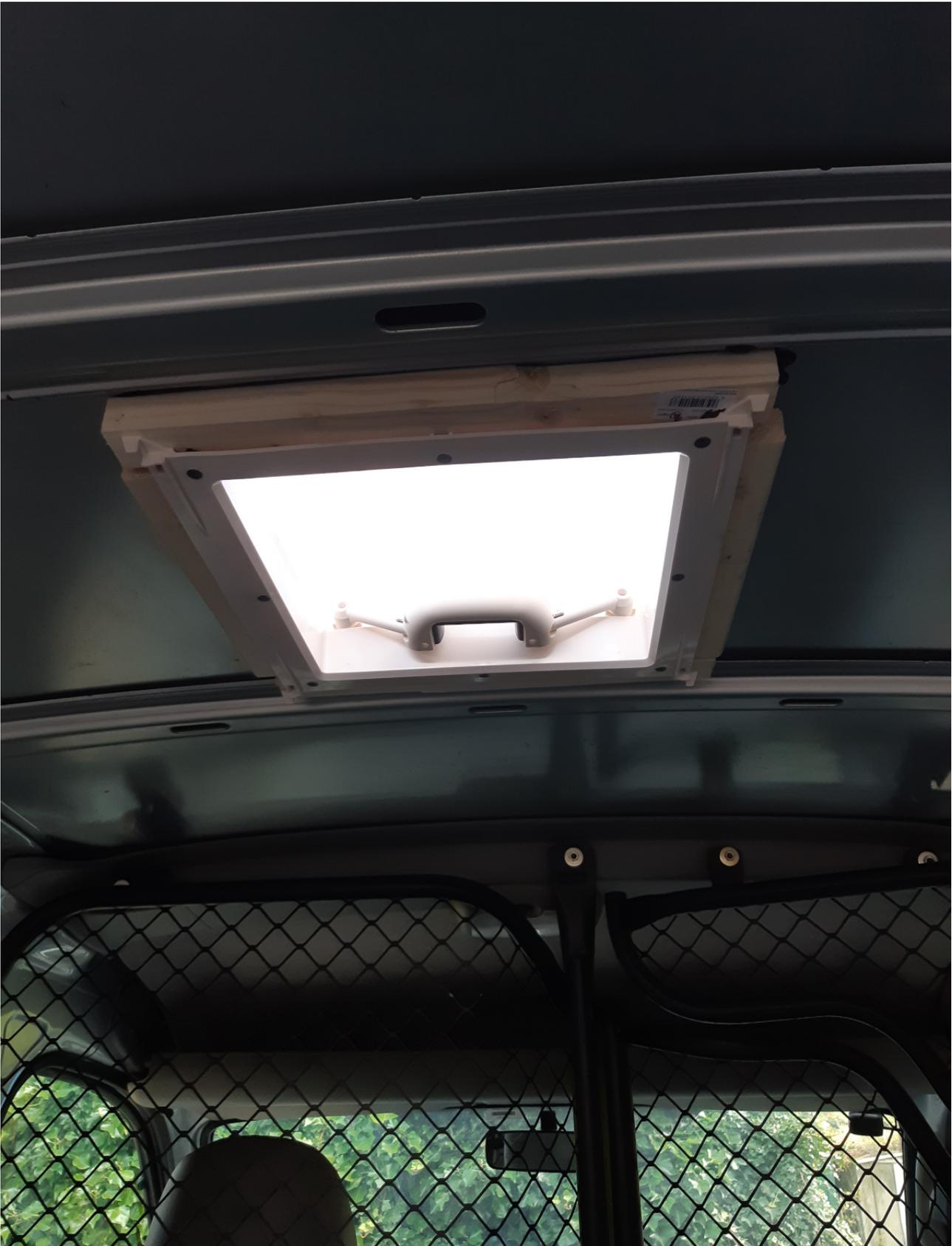
Die Öffnung wurde durch die Installation des Fliegengitters geschützt, hier noch von innen gegen
