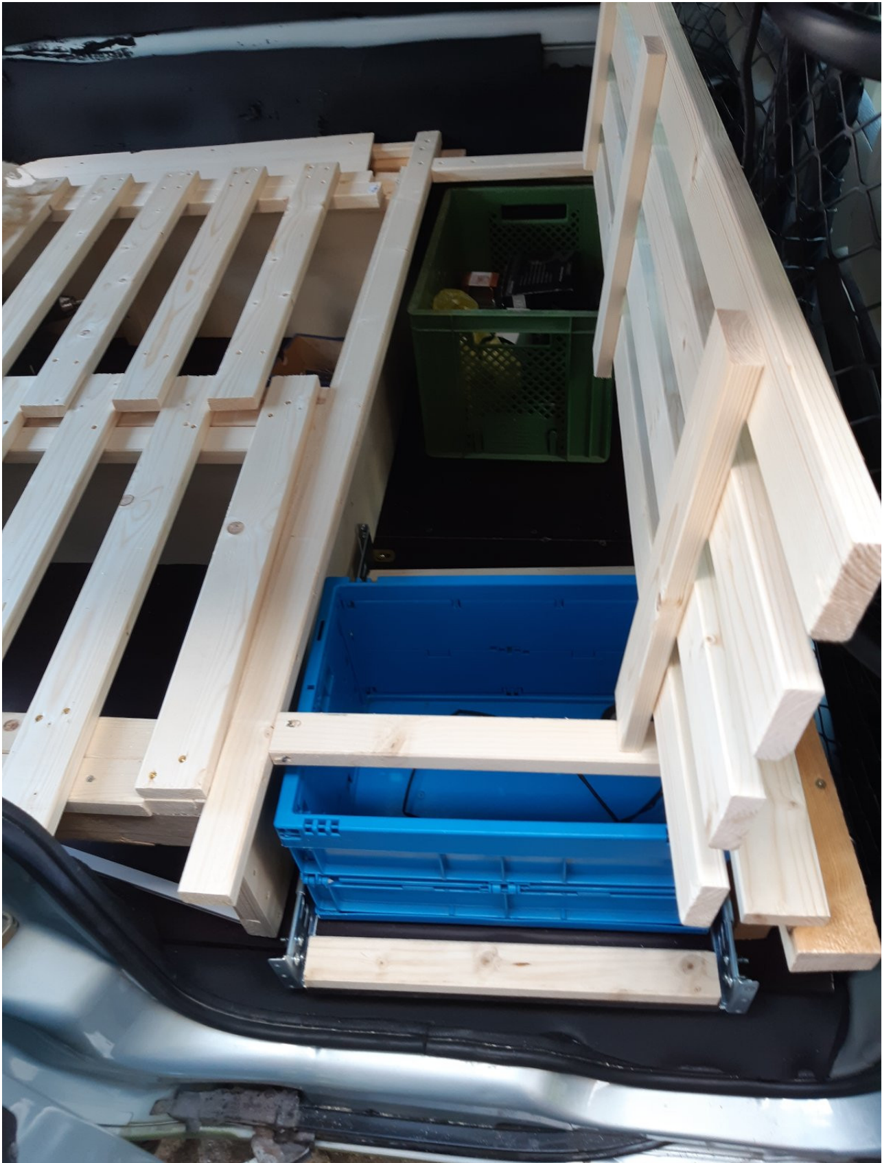
Die Lade mit dem selben Klappmechanismus wird dann als festes Bockgerüst der "Küchentisch"
