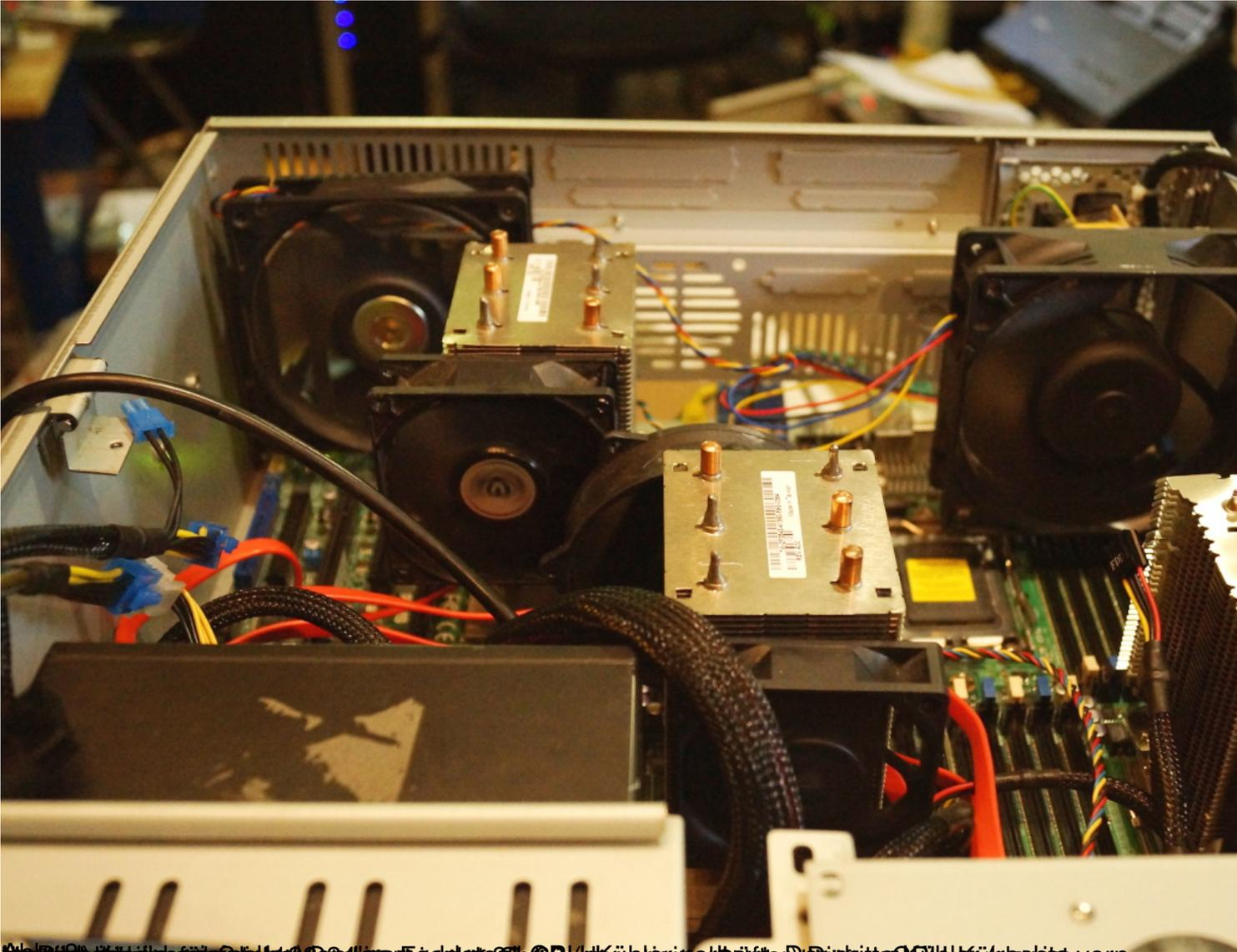
Abbildung 1: Interne Komponenten eines Servers (CPU, RAM, Festplatte, Netzteil, Lüfter, etc.)
